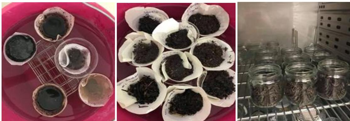
**Figure 3:** Détermination de la capacité de rétention d'eau (CRE) des substrats
